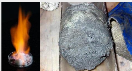
(左) 人工メタンハイドレートの燃焼写真 画像提供: メタンハイドレート資源開発研究コンソーシアム
